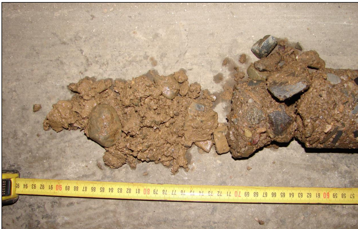
Foto 8: Základ Z2, 1.PP, starší přístavba; šterkopísek v oblasti základové spáry
