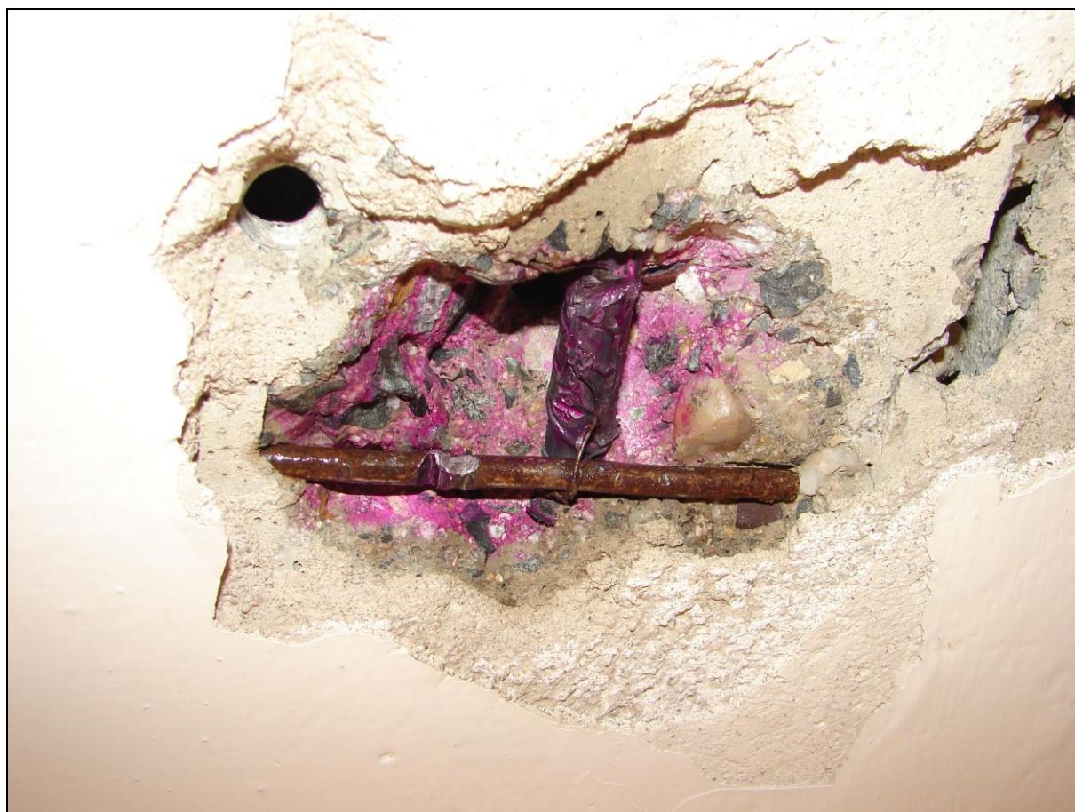
Foto 1: STROPNÍ PANEL P1, strop nad 1.NP; beton po kolorimetrickém testu hloubky karbonatace betonu, fialově zabarvený beton je nezkarbonatovaný, tj. „zdravý“ (ilustrativní foto)
