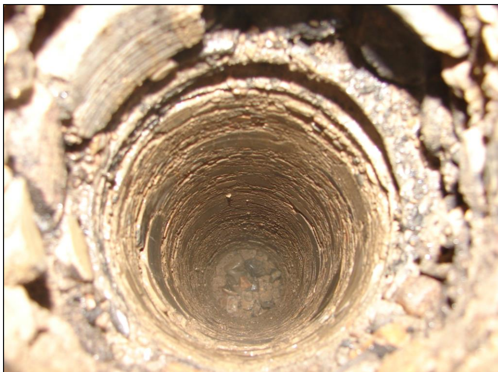
Foto 7: Základ Z2, 1.PP, starší přístavba; pohled do otvoru po ukončení jádrového vývrtu
