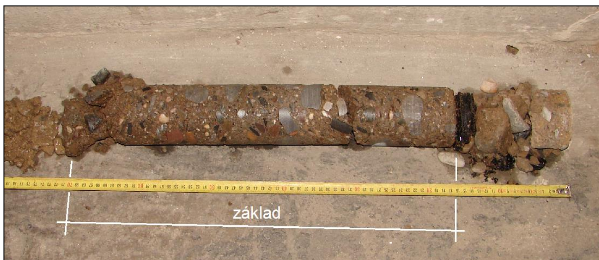
Foto 5: Základ Z2, 1.PP, starší přístavba; jádrový vývrt Ø 80 mm ze základu
